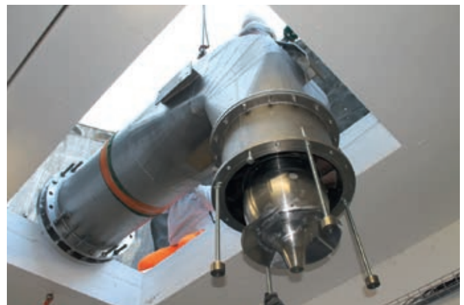
Montage de la turbine Diagonale de Montsalvens réalisée par la SARL Desgranges sur la base d'un profil hydraulique Mhylab (Q = 500 l/s, Hn = 40 m, Pm = 190 kW)
