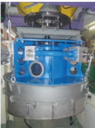
Turbine Pelton à 6 injecteurs conçue par Global Hydro Energy GmbH sur le banc d'essais Mhylab
