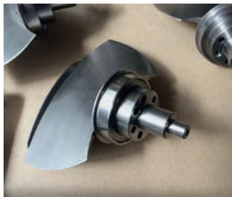
Le Day: une des 8 pales à collerettes définie selon un profil hydraulique Mhylab (Q = 600 l/s, Hn = 26,5 m, Pm = 139 kW)
